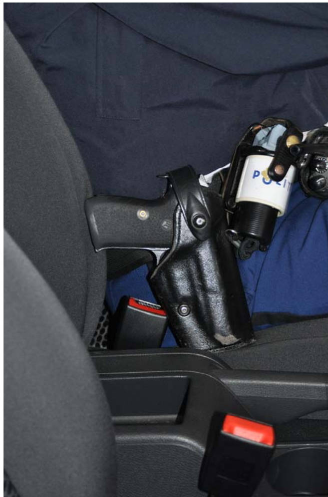
Figuur 1 De gordel kan niet worden aangelegd doordat de gordelstok onder/achter het wapen zit.
