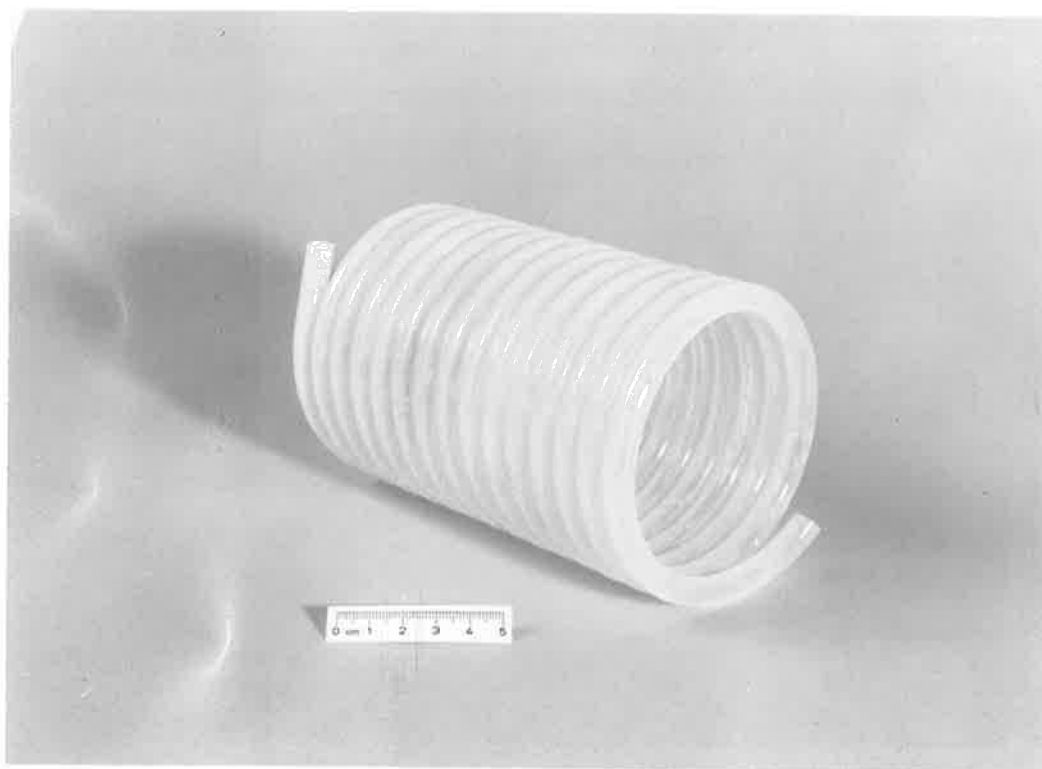
Figuur 4.3 De met \text{TiO}_2 -gecoate buis ten behoeve van de spiraalreactor
