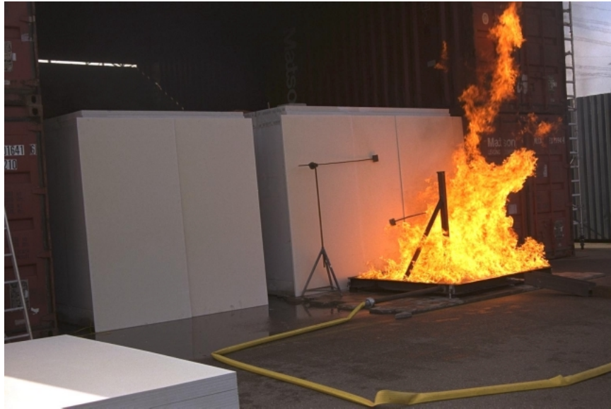
Figuur 3: Testproef om brandbelasting op de deur-kozijn-constructie van de bewaarplaats te testen.
