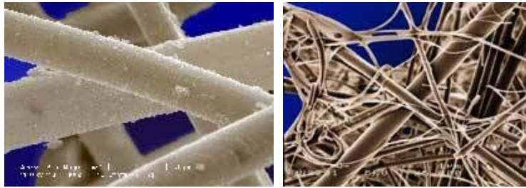
Figuur 20 Vezels van grove en fijne filters (Camfill Farr, 2008)
