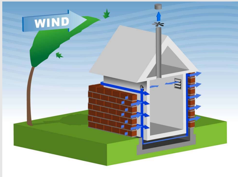
Figuur 4 Het verdeelringprincipe® vermindert oncontroleerbare lekstromen
