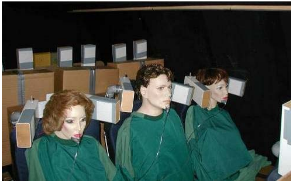
Figuur 8 lokale toevoer in de hoofdsteun van een vliegtuigstoel [Jacobs, 2006].
