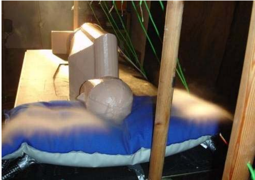
Figuur 7 Testopstelling voor beproeving van lokale toevoer van verse lucht in een ziekenhuisbed [Nielsen, 2007].
