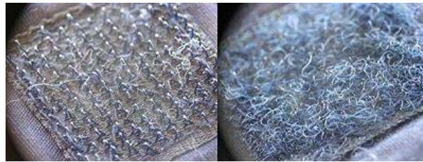
Figuur 19 Mechanische adhesie door middel van klittenband (inclusief vuil/stofverzameling)
