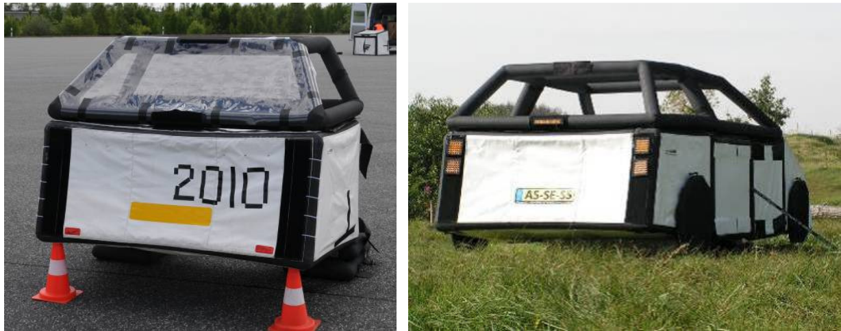
Abbildung 2: ASSESSOR Zielobjekt (links: nur Heckteil, rechts: vollständig) – ergänzend zur hier dargestellten Version können Rückleuchten, Reflektoren etc. montiert werden.
