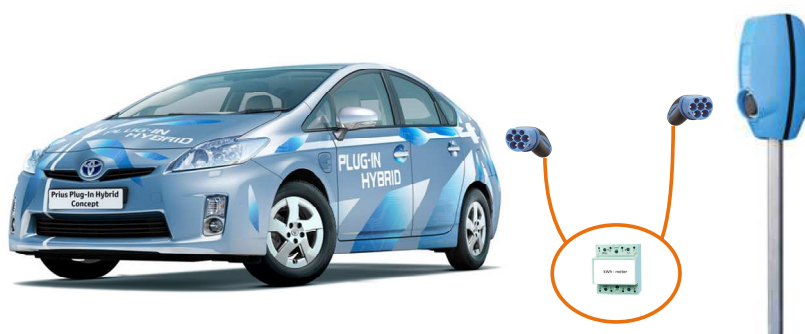
Figuur 2 Oplaadkabel Toyota Prius plug-in met kilowattuurmeter voor het monitoren van de geladen energie van het net
